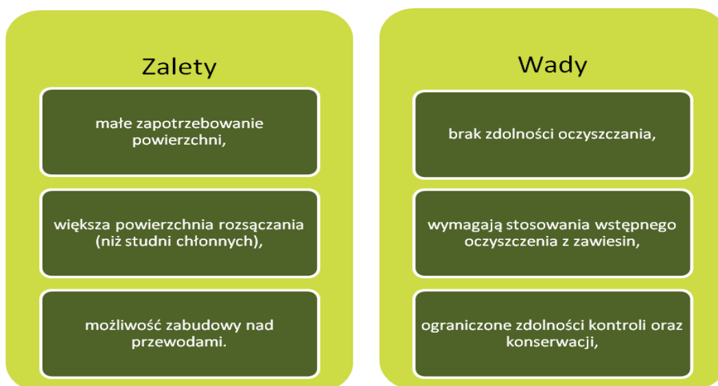
Rysunek 18. Wady i zalety stosowania rur drenarskich
