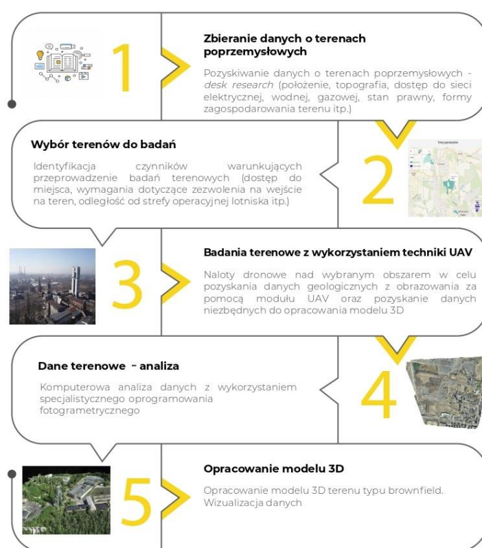
Rys. 1. Etapy inwentaryzacji terenów poprzemysłowych z wykorzystaniem techniki UAV w ramach budowy bazy danych o terenach poprzemysłowych
