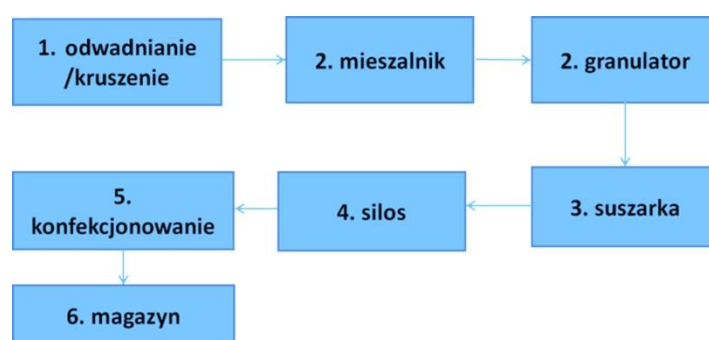
Rys. 1. Schemat procesu powstawania trwałego niepyłającego granulatu na bazie substratu z PGG SA
